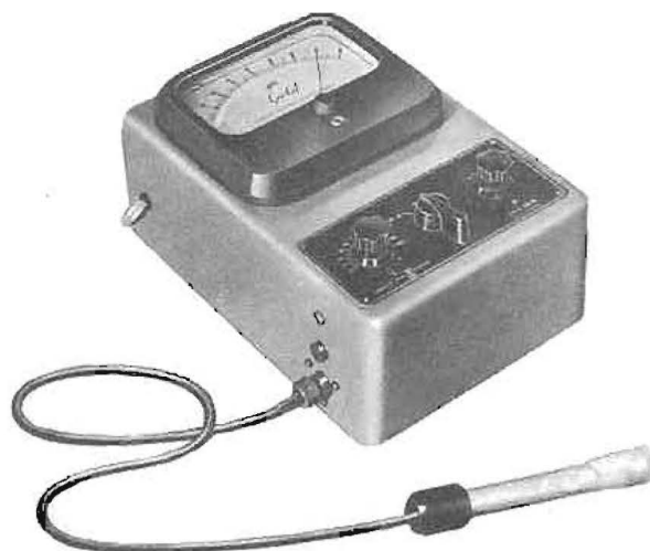
PH-metro Grl-ccl Los electrodos de medida están contenidos en la sonda que aparece al pie.
