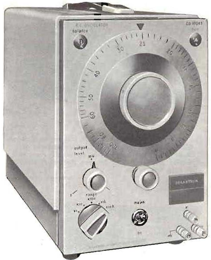
Figura 23. — Generador de baja frecuencia. Con dos salidas de fase invertida. Tensión máxima de salida: 20 V. Impedancia para esta salida: 20 KΩ. Margen de frecuencias: de 10 a 1.000.000 Hz.
