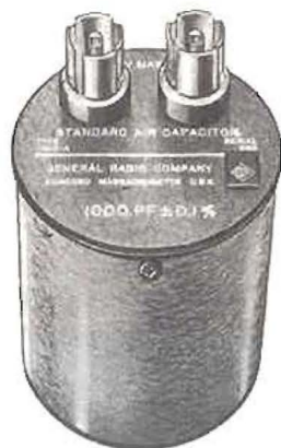
Los patrones de capacidad, autoinducción y resistencia se fabrican con mucho más esmero que los condensadores, las bobinas o las resistencias empleadas en los montajes. A fin de protegerlos están alojados en cajas adecuadas. En la fotografía, tres patrones de Radio Company.
