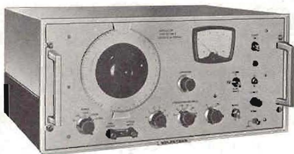
Figura 25. — Generador de baja frecuencia. Tensión máxima de salida: 5 V. Con atenuadores calibrados en dB. Impedancia de salida para la tensión máxima: 75 \Omega . Margen de frecuencias: de 25 a 500.000 Hz.
