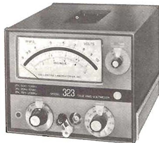
Voltímetro electrónico para valores eficaces Ballantine. El margen de frecuencias en que es utilizable se extiende desde 10 Kc/s a 20 Mc/s; el margen de tensiones se extiende entre 300 \mu V y 330 V.
