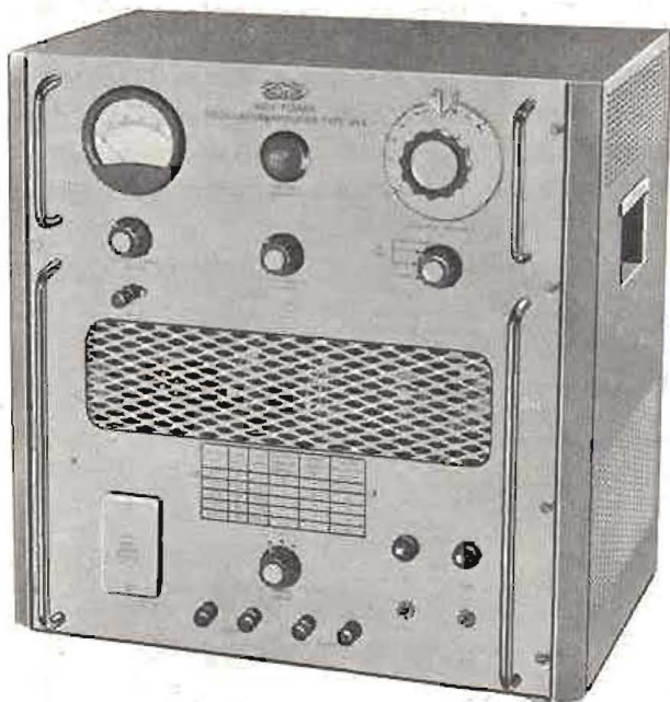
Figura 20. — Generador de baja frecuencia. De alta potencia (150 W). Tensión máxima de salida: 800 V. Impedancia para esta salida: 4.270 \Omega . Margen de frecuencias: de 30 a 30.000 Hz.
